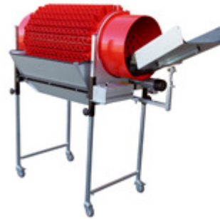
„Igeltrommel“ zum Separieren verhakungsfreudiger oder sichelförmiger Teile Foto: MTF
