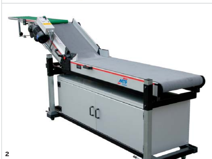
Die erste Multi-Change-Förderband-Austragsförderbandkombination für Stanzbetriebe von MTF Technik steht bei Härter.
