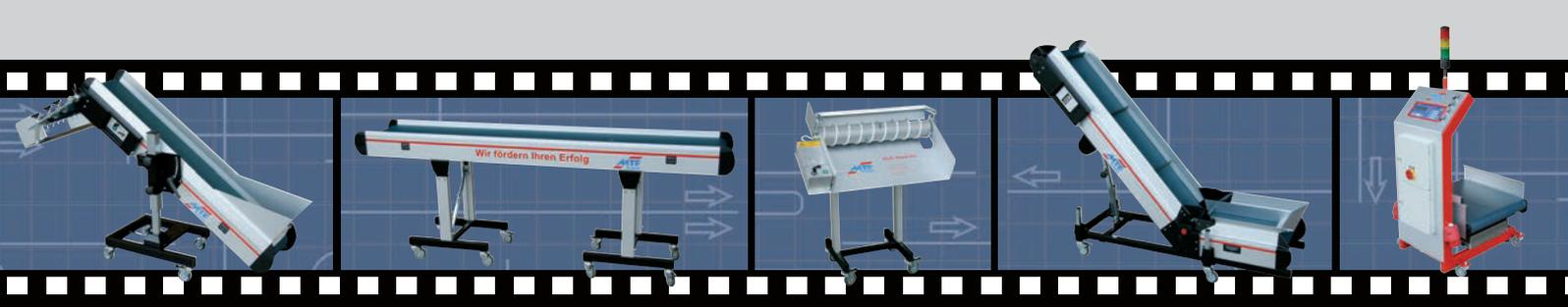
Der **MTF Multi-Rounder** ist Bestandteil des Multi-Tech Programms. Mit seinem Aktionsradius von 360° dient er zum stückzahlgenauen Befüllen unterschiedlicher Behälter und damit zur Automatisierung des Materialmanagements.
