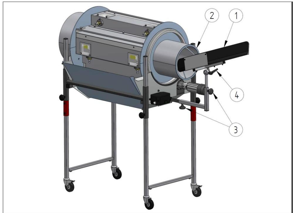
Abb. 11: Einstellmöglichkeiten der Einlaufrutsche
