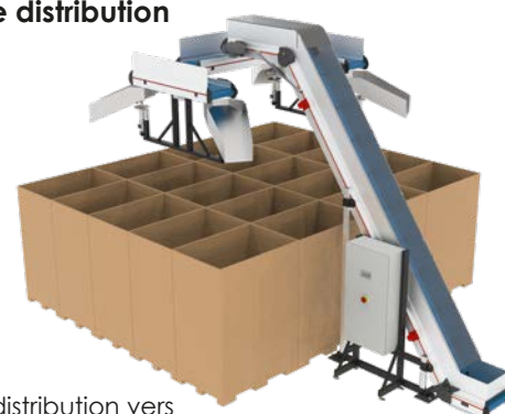
Dispositif de distribution
