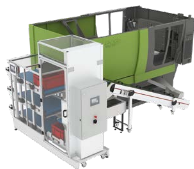
Système de levage pour salle blanche
