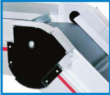
Isolamento ottimale del nastro in tutto lo snodo superiore
