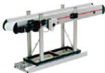
Struttura di supporto con avanzamento rettilineo
