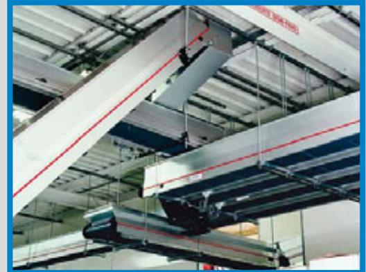
Automazione gestita da computer tra pressa a iniezione e macchina di stampa: i pezzi stampati a iniezione vengono distribuiti sui nastri trasportatori inclinati MTF a regolazione pneumatica.
