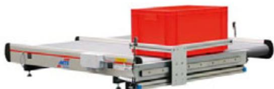
**Bufferizzatore rettilineo con slitta singola**
