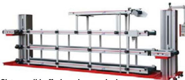
**Sistema di bufferizzazione a piani con doppio elevatore e nastro piano robotizzato**
