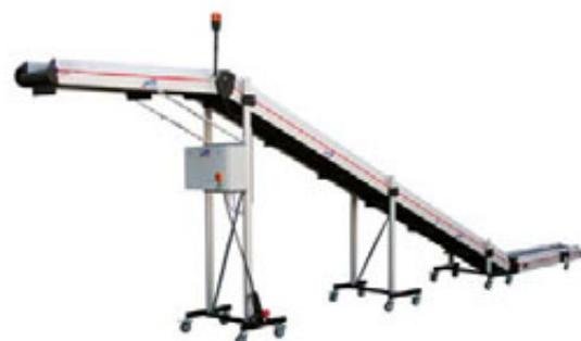
**Nastro a Z con sistema di ricerca metalli**
