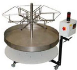
**Impianto di raccolta con vasche in acciaio inox per "camera bianca"**
