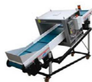
Nastro elevatore a tazze con rilevatore a tunnel
