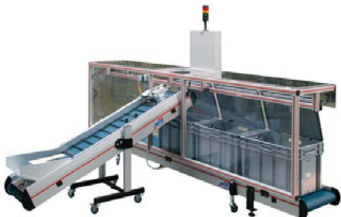
**Bufferizzatore rettilineo con nastro trasportatore**
