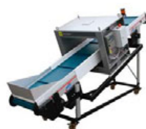
Taśmy do przesyłki mięsa z detektorem tunelowym
