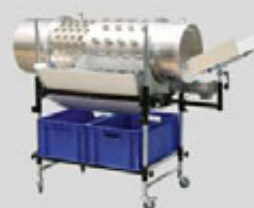
Połączenie bębna z otworami z bębniem „jeź”
