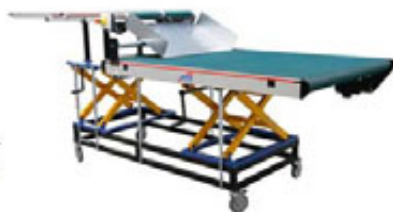
Dopasowanie wysokości przy użyciu podnoszonego stołu
