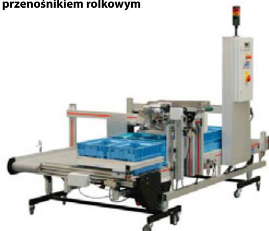
Liniowe urządzenie buforowe z suwakiem dwustopniowym
