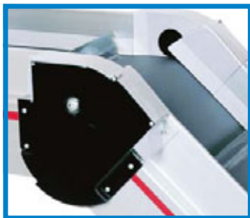
Optymalne uszczelnienie w całym obszarze skrętu taśmy
