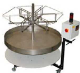
Urządzenie zbierające z wanną ze stali nierdzewnej dla pomieszczenia sterylnego
