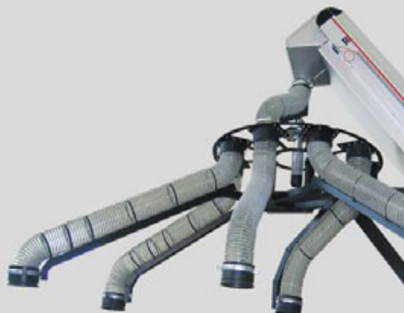
Specjalne urządzenie do zautomatyzowania transportu i dystrybucji zakrętek do napojów do kilku dużych zbiorników.
