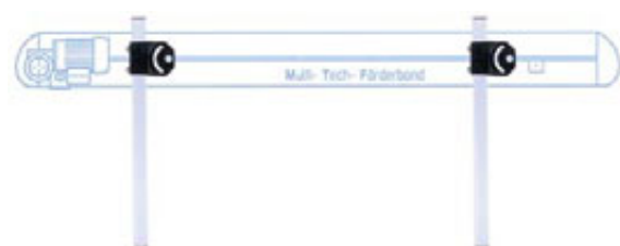
AM 140, stabilne podpory do zmiany wysokości, najlepiej dopasowane dla powierzchni o nierównej wysokości, takich jak stopnie lub zejściówki.
