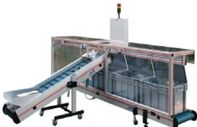
Liniowe urządzenie buforowe dla pomieszczeń sterylnych z taśmą dostarczającą
