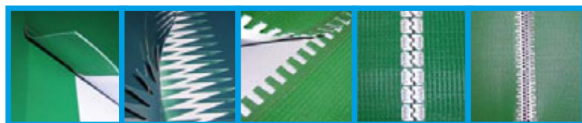
dwuwarstwowe połączenia stopniowe
