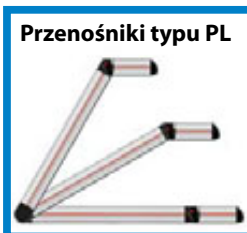
Wszystkie zmiennokątowe przenośniki MTF Multi-Tech dysponują standardowo płynną, bezstopniową możliwością zmiany kąta nachylenia w pełnym zakresie 0 - 60°.
