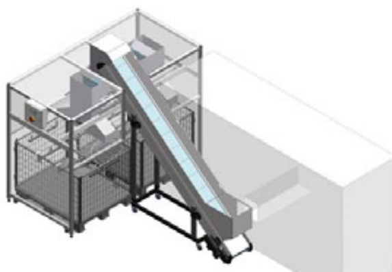
12-pojemników do napełniania z pneumatycznym przemieszczaniem taśmy i dwustronnym zwrotnicą trójpozycyjną
