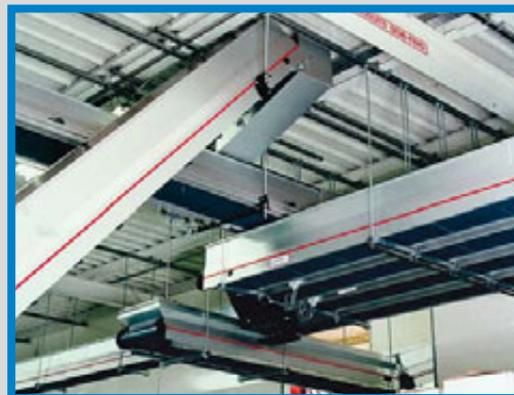
Система автоматизации между термопластавтоматом и печатной машиной с управлением от компьютера: посредством поперечных конвейеров с пневматической регулировкой от MTF Technik детали, выполненные литьем под давлением, распределяются по следующим транспортерам.
