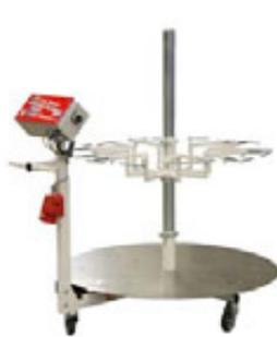
**Накопительная установка в исполнении, предназначенном для чистых помещений, с подпружиненными зажимами для мешков и поворотным столом из нержавеющей стали**
