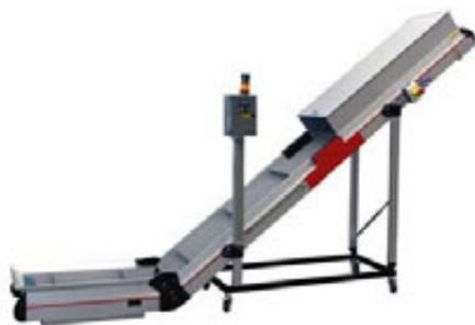
Транспортер для подачи в дробилку с металлодетектором
