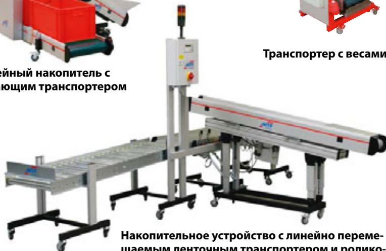
Накопительное устройство с линейно перемещаемым ленточным транспортером и роликовым транспортером
