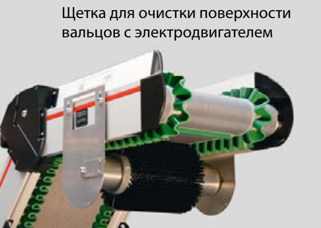
Щетка для очистки поверхности вальцов с электродвигателем
