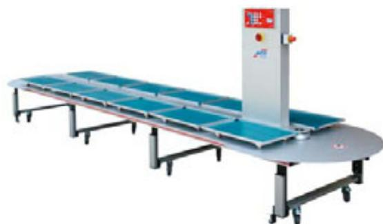
Установка Multi-Linea с регулируемой по высоте опорной рамой
