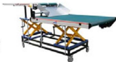
Подгонка по высоте с помощью подъемного стола ножничного типа
