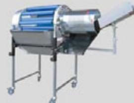
Роликовый сепарационный барабан с перфорированным барабанным-загрузочным кольцом
