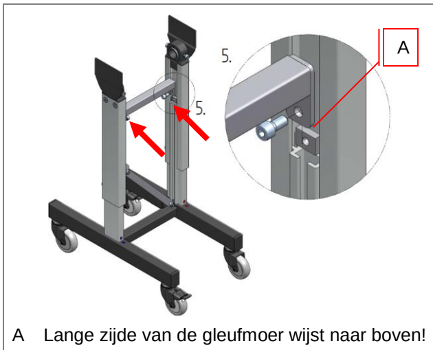
Afb. 34: Montage van het onderstel – HE 050/ HM 480
