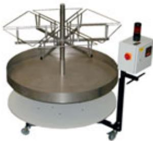
Aufnahmeanlage mit Edelstahlwanne für den Reinraum
