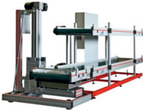
Etagenpuffer mit Lift und Waage
