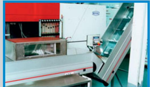
Ein geschlossenes System: Die Übergabe aus der Spritzgussmaschine auf die MTF Förderanlage.
