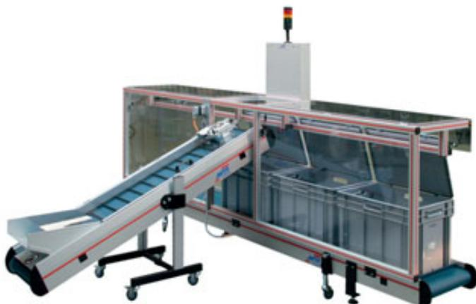
Reinraum Linearpuffer mit Zuführband
