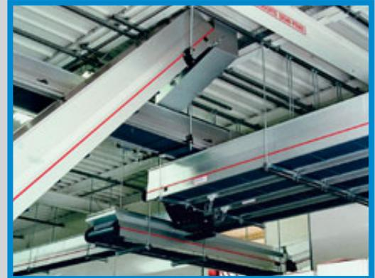
Computergesteuerte Automation zwischen Spritzguss- und Druckmaschine: Über die pneumatisch verstellbaren Quer-Förderbänder von MTF Technik werden Spritzgussteile auf weiteren Förderbändern verteilt.
