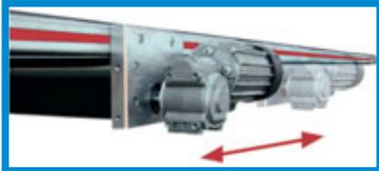
**Mittelantrieb** mit seitlich angeflanschem Motor
