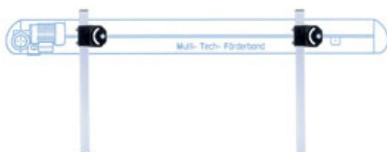
**AM 140**, stabile, höhenverstellbare Einzelstützen, beste Eignung für unterschiedliche Bodenhöhen, wie Stufen oder Maschinenschächte.
