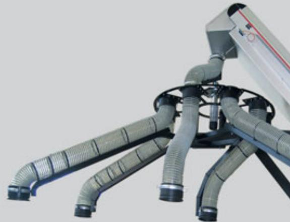
Sonderanlage zur automatisierten Förderung und Verteilung von Getränkeverschlusskappen in mehrere Großbehälter.
