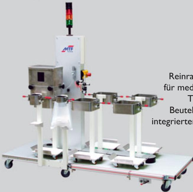
Multi-Linea in Reinraumausführung für medizintechnische Teile mit 6-fach Beutelaufnahme und integrierter QS-Funktion
