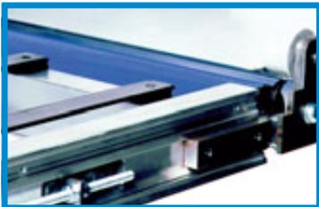
Der im Bandkörper integrierte Kurvenschieber sorgt für gleichbleibende Laufdeckenspannung über den gesamten Winkelverstellbereich (Patent)
