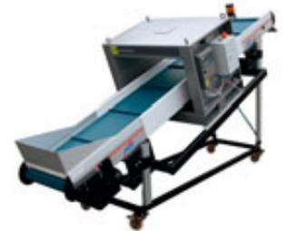
**Mühlenbeschickungsband mit Tunneldetektor**
