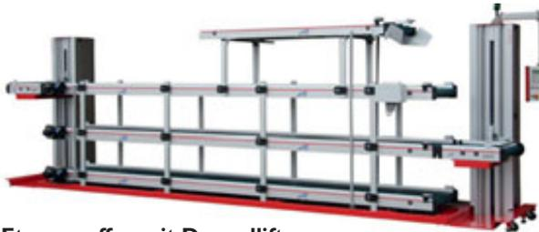
Etagenpuffer mit Doppellift und Roboter-Ablageband
