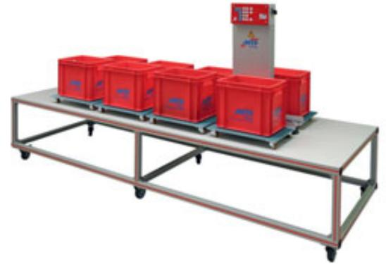
Multi-Linea mit 6-fach Behälteraufnahme und Sonder-Untergestell
