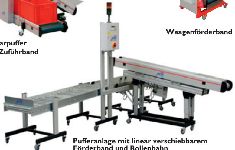
Pufferanlage mit linear verschiebbarem Förderband und Rollenbahn
