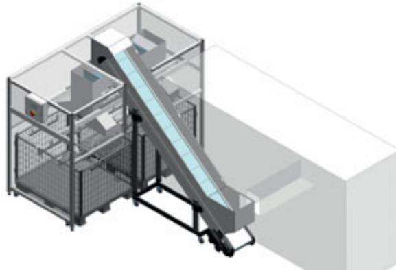
12-fach Beutelbefüllung mit pneumatischem Verschiebeband und doppelseitigen 3-Wege Weichen
