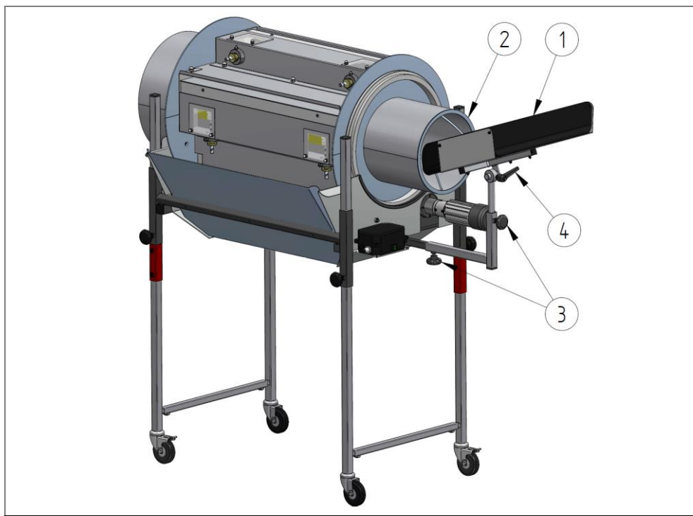
11. ábra: Az adagolócsúszda beállítási lehetőségei
