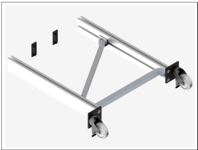
27. ábra: Az AM 140 alváz (példa) szerelése
