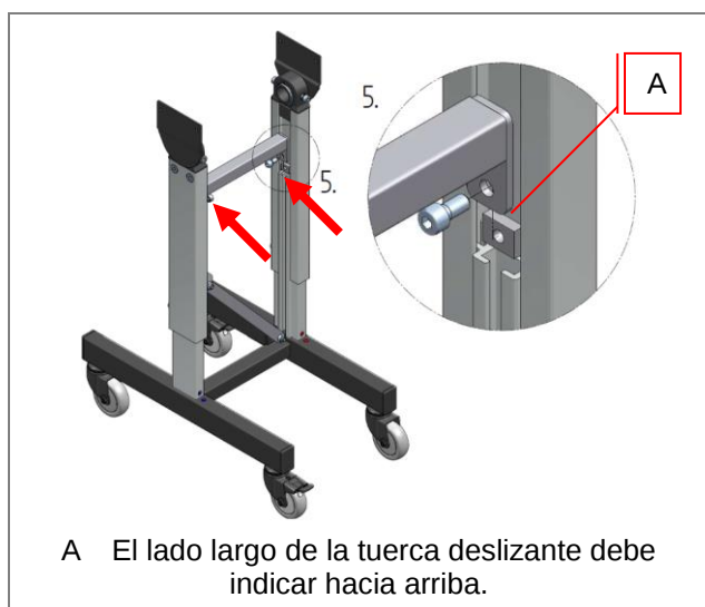
Fig. 34: Montaje del bastidor inferior – HE 050/ HM 480
