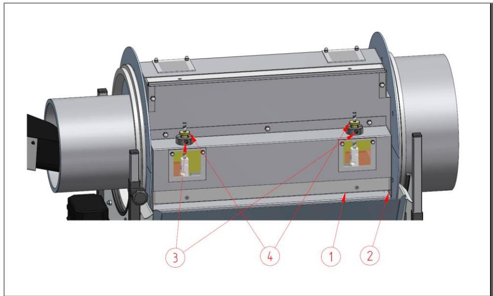
Fig. 9: Ajustar la ranura de separación
