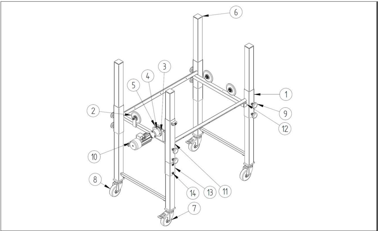
Fig. 20: Lista de piezas: Bastidor inferior – reforzado – ZZ.860.0021
