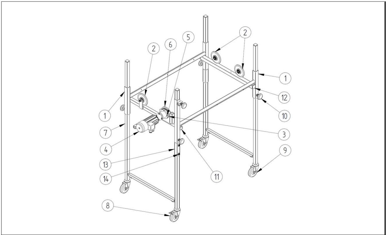
Fig. 19: Lista de piezas: Bastidor inferior – Tambor de separación – ZZ.860.0003
