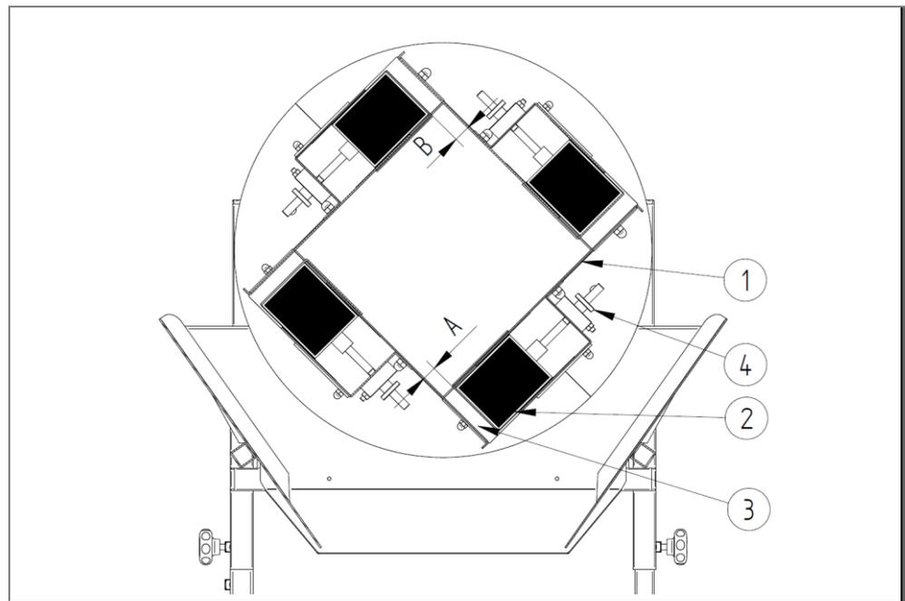
Fig. 4: Canales de descarga del tambor de separación en diferentes posiciones
