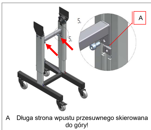
Rys. 34: Montaż ramy podstawy – HE 050/ HM 480
