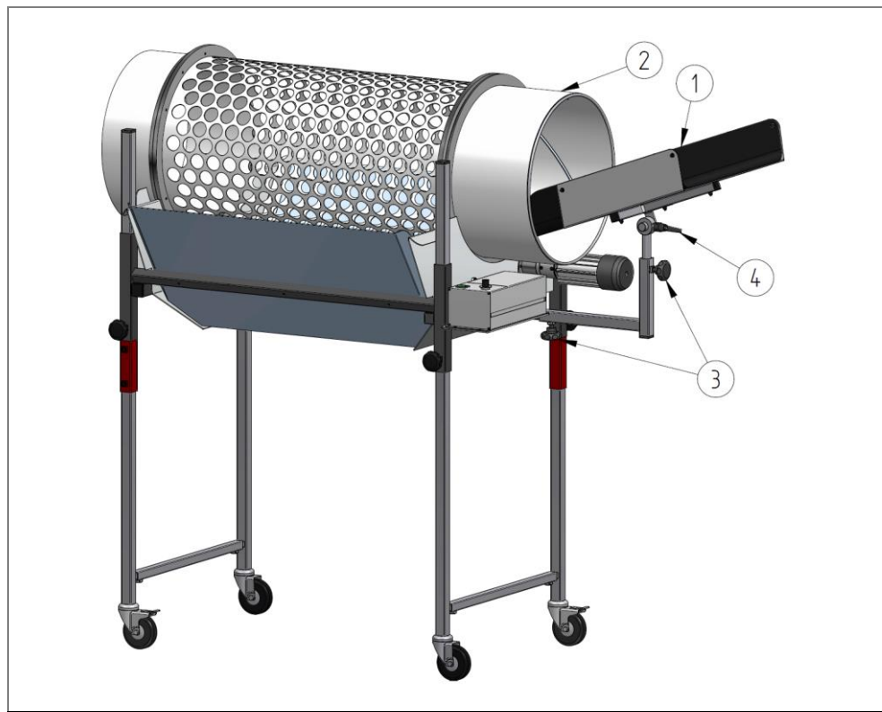
Rys. 10: Możliwości ustawienia zsuwni wlotowej
