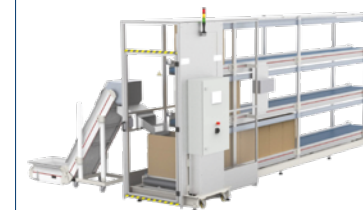
Etážové dopravníkové zařízení se zvedacím systémem
