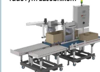
Dopravní pás s řadovým zásobníkem
