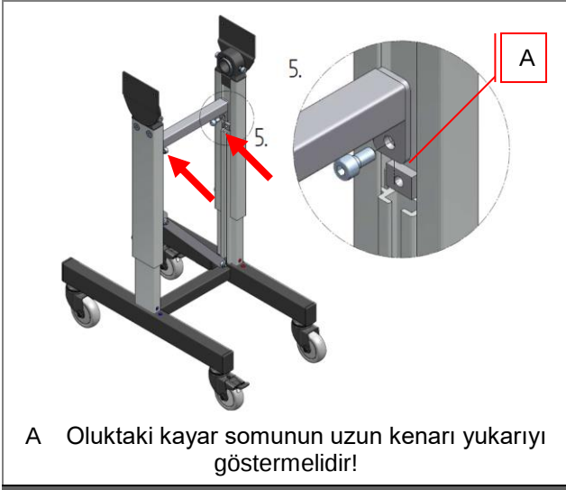
Şekil 34: HE 050 / HM 480 alt şasisinin montajı
