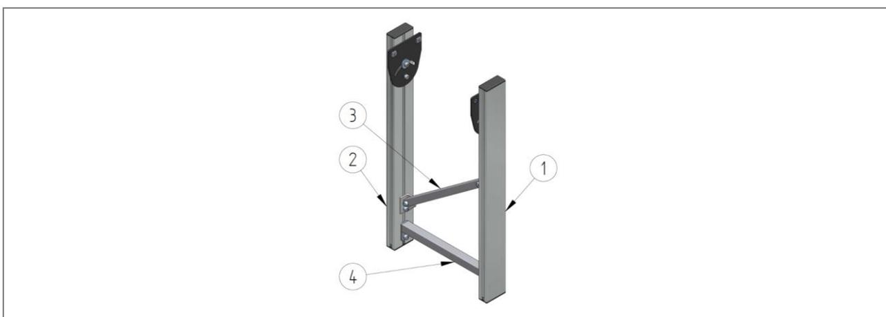
Fig. 94 : Support de bande de convoyage AM 1030 – ZZ.982.0084
