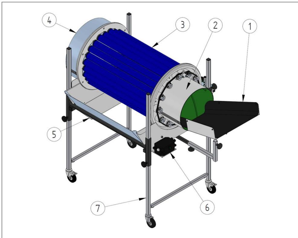
Fig. 3 : tambour à séparer à réglage planétaire centralisé
