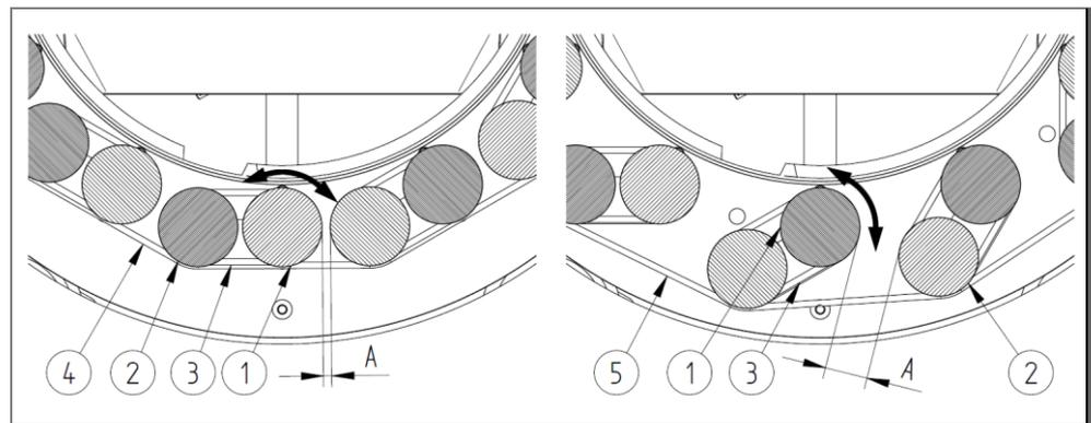
Fig. 4 : différentes positions des paires de rouleaux du tambour à séparer
