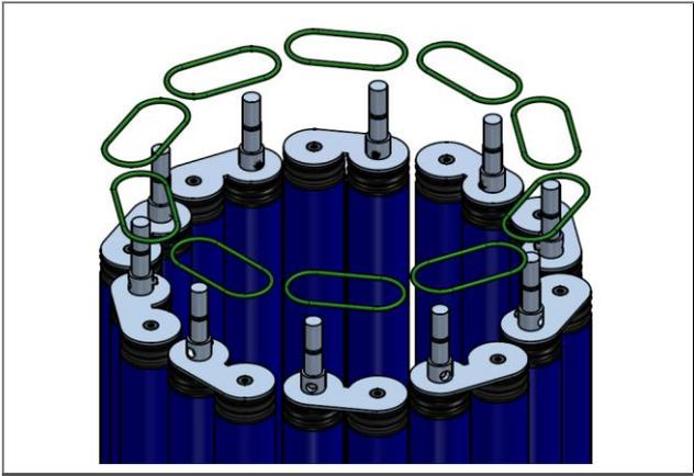
Fig. 18 : remplacement des courroies rondes
