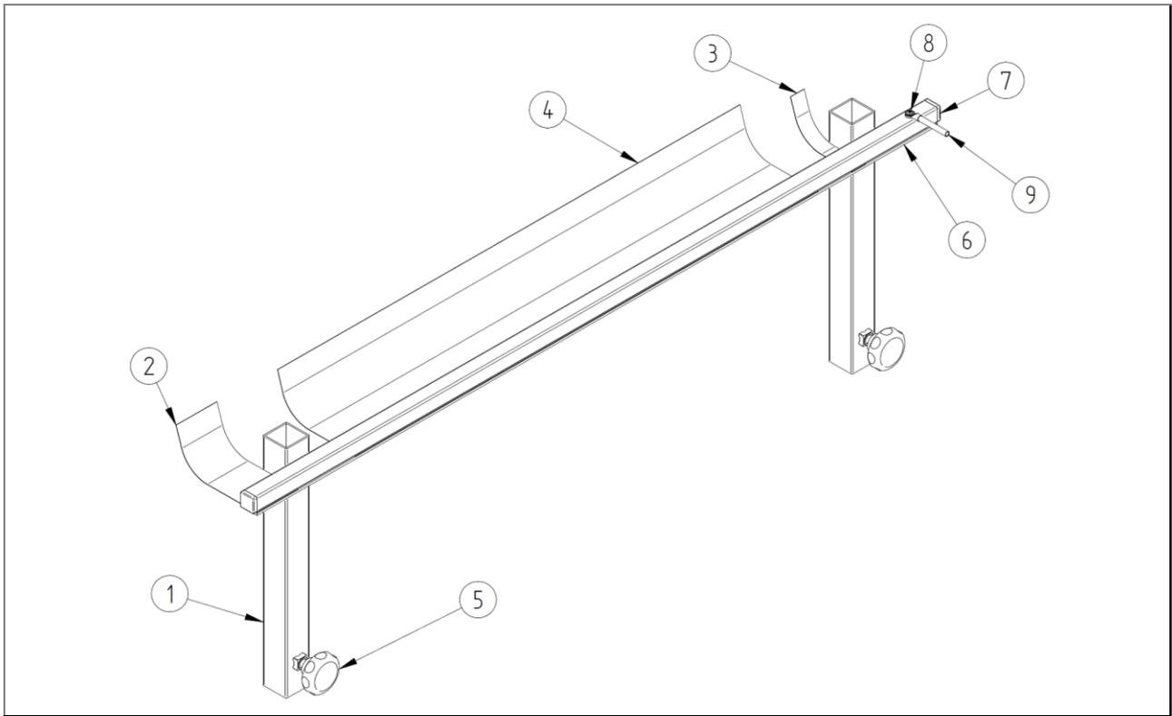
Fig. 33 : Nomenclature des accessoires : dispositif antistatique - ZZ.867.0003
