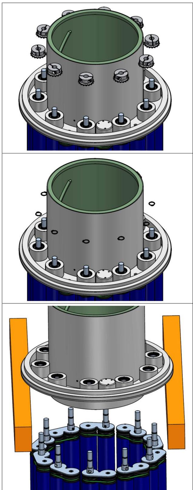
5. Desserrez les vis à six pans creux du pignon de chaîne et retirez le pignon de chaîne dès qu'il ne tient plus.
