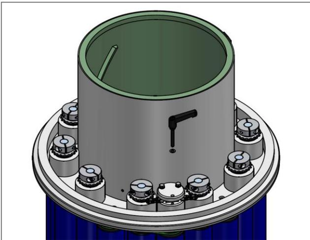
1. Desserrez le levier de serrage du réglage centralisé et dévissez-le entièrement.
