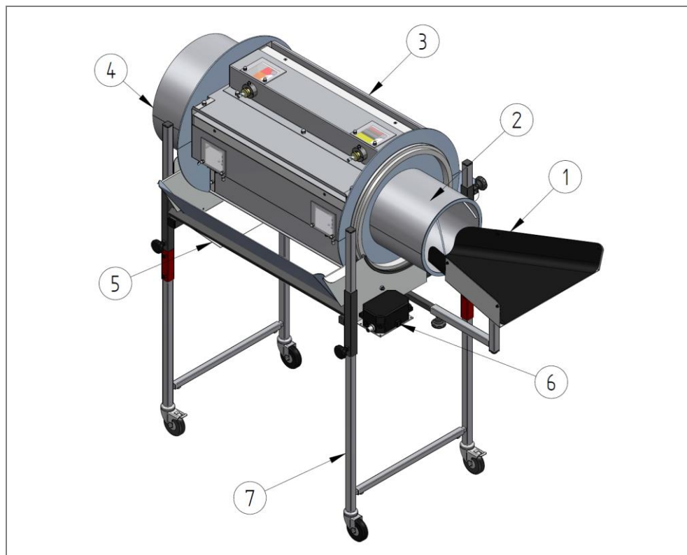
Fig. 3 : Tambour à séparer rectangulaire
