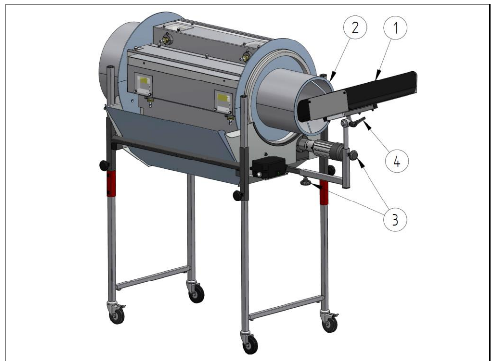
Fig. 11 : Réglages possibles pour la goulotte d'admission
