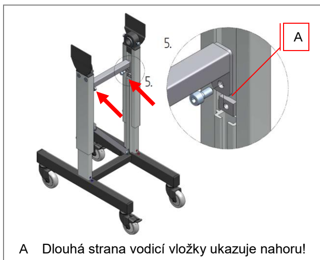
Obr. 34: Montáž stojanu – HE 050/ HM 480
