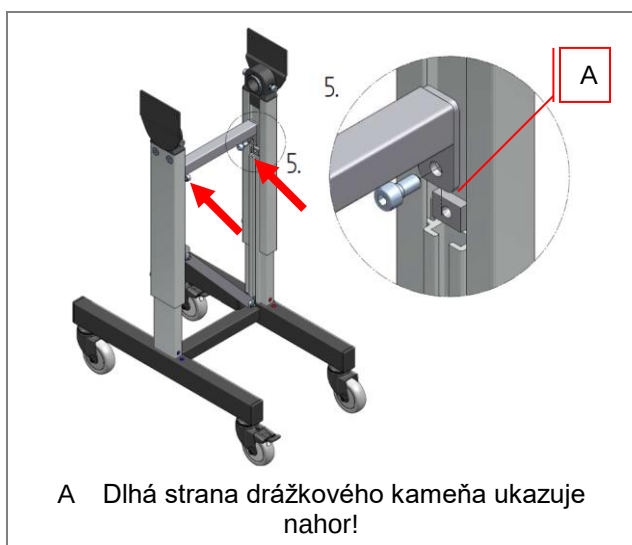
Obr. 34: Montáž podstavca – HE 050/ HM 480
