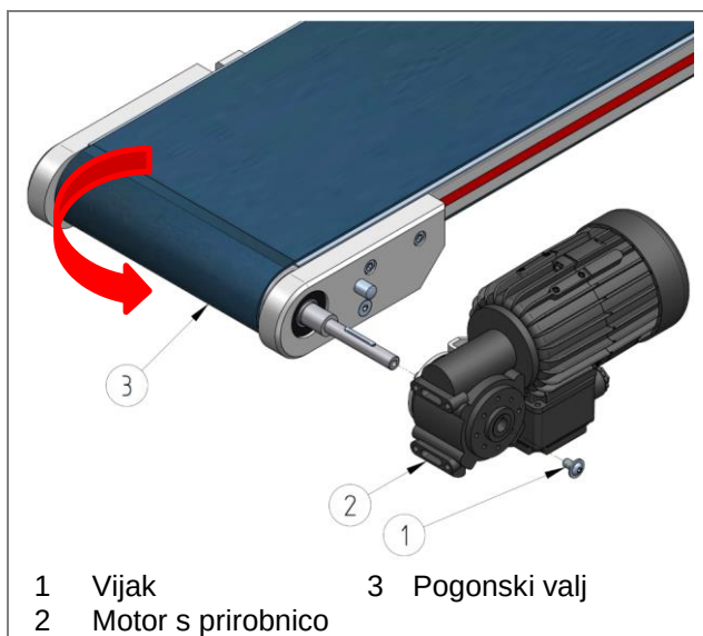
Slika 69: Pogon s prirobnico: preverjanje gladkega teka traku
