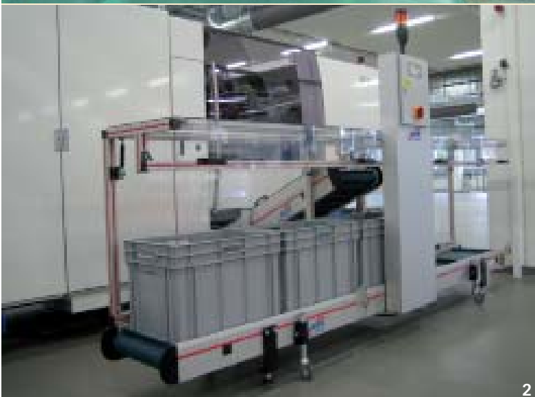
1 Förderanlage zur Verkettung von Spritzgieß- und Druckmaschinen für Tablettenröhrchen
