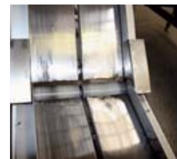
Abrieb kann auch im Inneren des Bandkörpers entstehen. Bild: MTF
