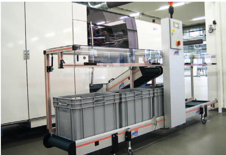
Einfach zu reinigende Abdeckungen aus Polycarbonat kapseln das Förderband gegen Umgebungseinflüsse
