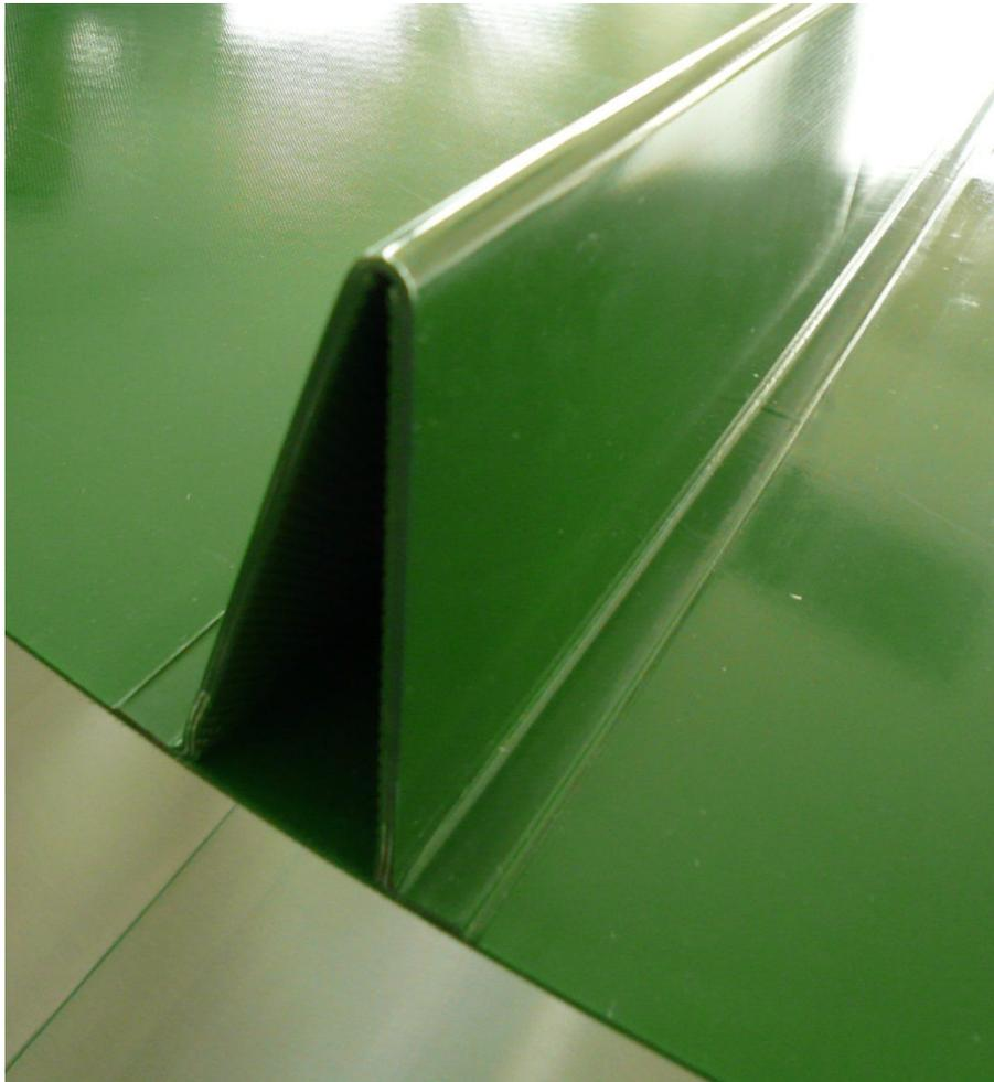
Foto zeigt Ausführung in PVC-Bandmaterial
