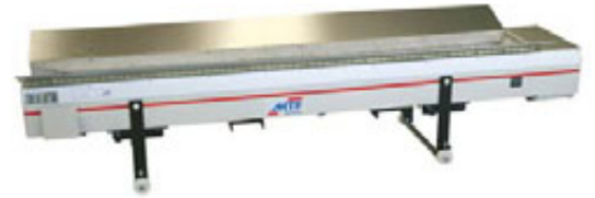
met edelstaal geleidingsplaten en speciaal frame
