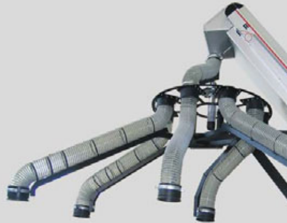
Speciale installatie voor het automatische transport en de verdeling van frisdrankdoppen in meerdere containers.
