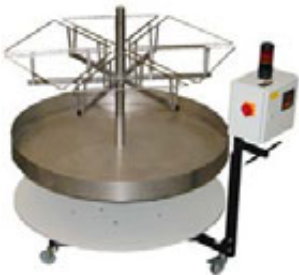
Houderinstallatie met edelstalen bak voor de geconditioneerde werkruinte
