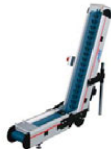
Transportbandcombinatie voor transport van muntrollen
