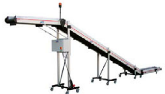
Z-band met metaaldetectie-installatie
