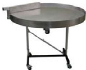
Edelstalen indexeer-tafel met draaiplaat
