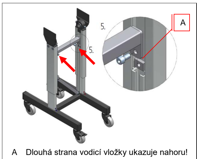
Obr. 34: Montáž stojanu – HE 050/ HM 480
