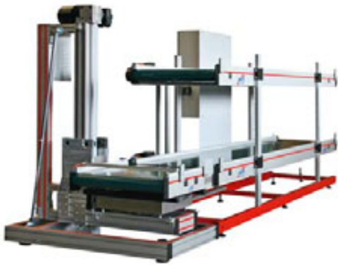
Etážové vyrovnávací skladování s výtahem a váhou
