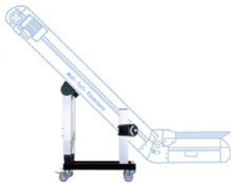
LD 020 , na stabilním základním rámu, vysouvací, s velkou nosnou silou a výškově nastavitelnými zdvojenými oporami.
