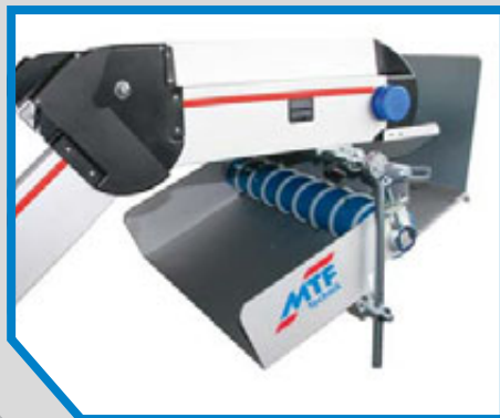
Šnekový separační nástavec Typ SAL speciál Dle přání zákazníka byl nástavec namontován tak, že byly separované díly shazovány ke středu pásu
