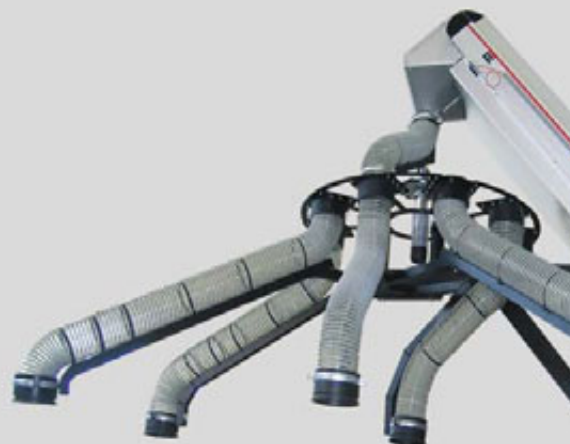
Speciální zařízení pro automatizované dopravování a rozdělování více lahví ve větších kontejnerech.
