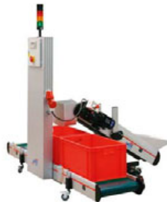
Lineární vyrovnávací skladování dílů s přívodním pásem
