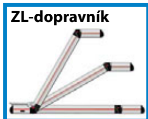
U všech MTF Multi-Tech lomených pásových dopravníků jsou lomy dopravníku standardně plynule nastavitelné v rozmezí 0° až 60°.
