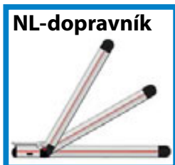
U všech MTF Multi-Tech lomených pásových dopravníků jsou lomy dopravníku standardně plynule nastavitelné v rozmezí 0° až 60°.
