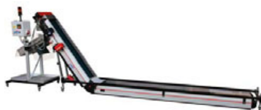
Provedení pro čisté prostředí s ionizací a rozdělovací hranou
