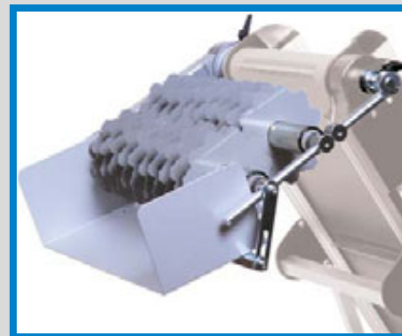
Kotoučový separátor Typ SSA 400-2 Kotoučový separační nástavec se používá všude tam, kde je zapotřebí bezstupňové nastavení délky separační mezery.
