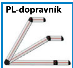
U všech MTF Multi-Tech lomených pásových dopravníků jsou lomy dopravníku standardně plynule nastavitelné v rozmezí 0° až 60°.
