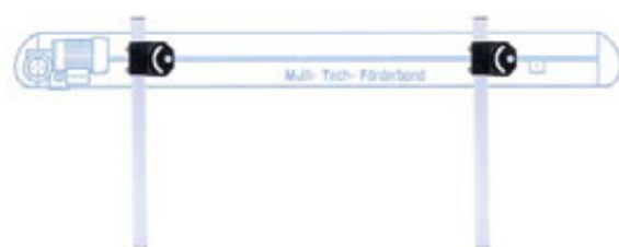
AM 140 , stabilní, jednotlivé podpěry výškově nastavitelné, ideální pro podlahy s různou výškou, jako stupňování nebo šachty strojů.
