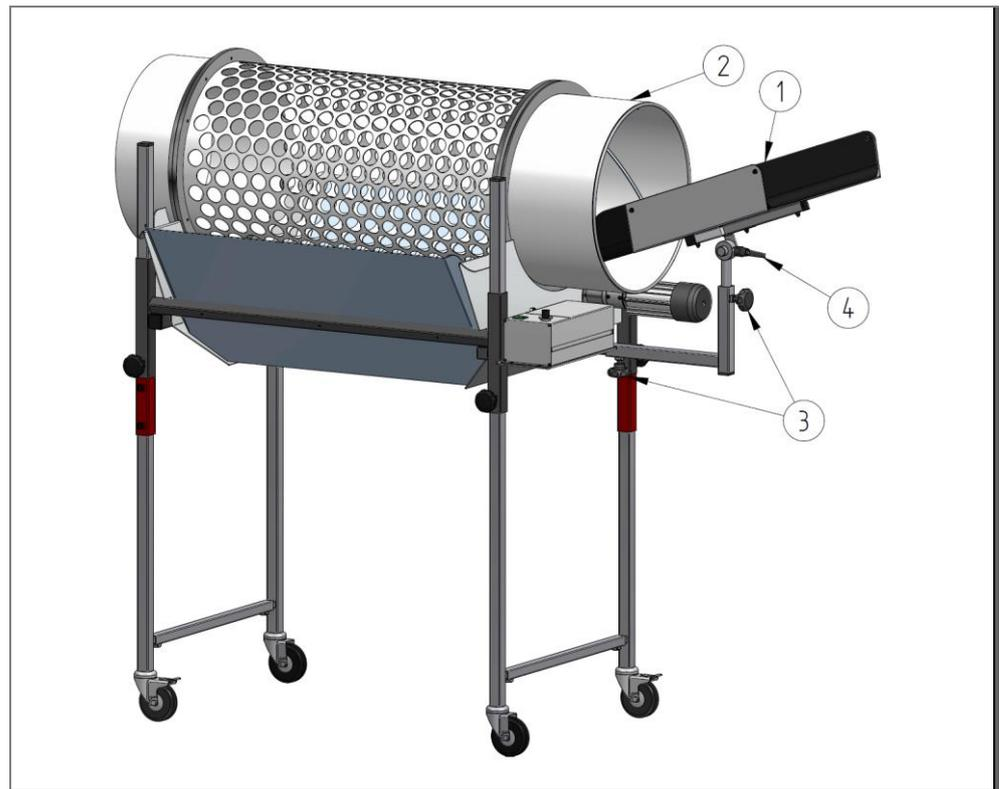
Abb. 10: Einstellmöglichkeiten der Einlaufrutsche
