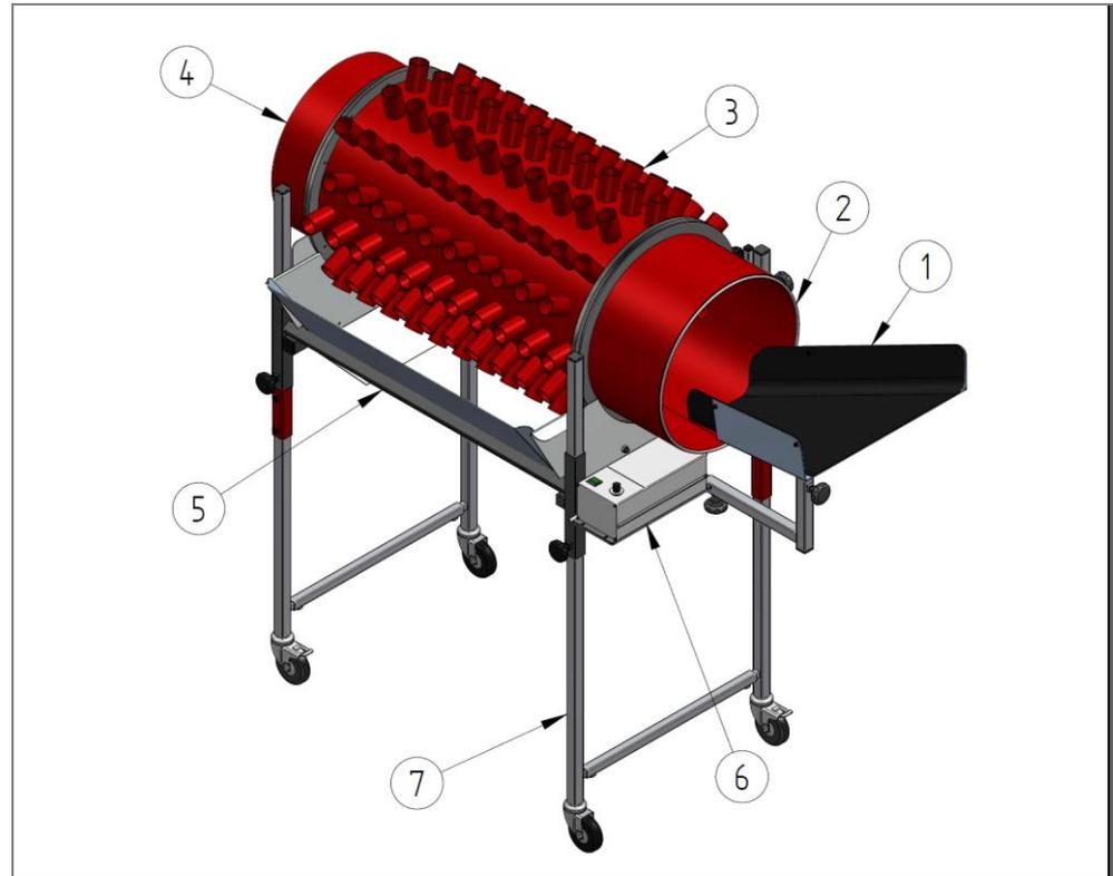
Abb. 3: Separiertrommel mit Einzelverstellung
