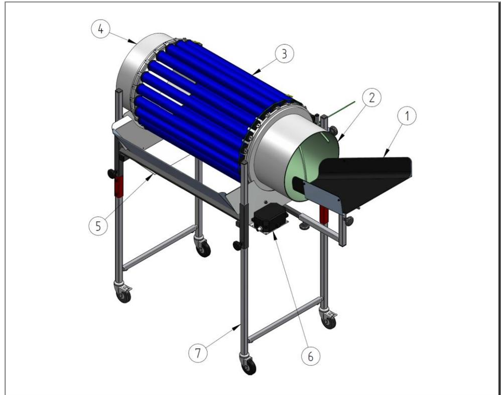
Abb. 3: Separiertrommel mit Einzelverstellung
