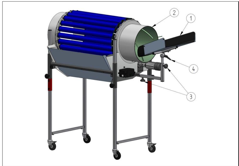
Abb. 12: Einstellmöglichkeiten der Einlaufrutsche
