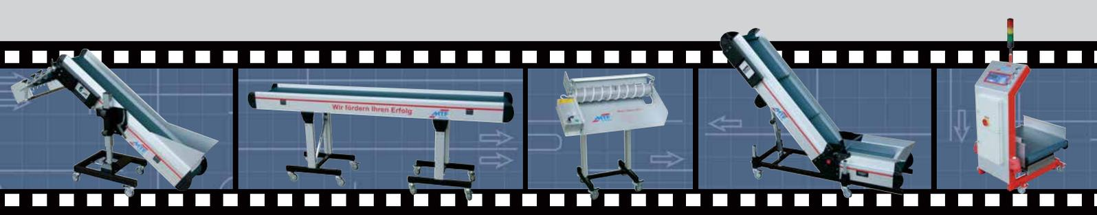
Die **MTF Trennwalzen-Separiervorsätze Typ TA** und **Schnecken-Separiervorsätze Typ SAL/SAR** sind Bestandteil des Multi-Tech Programms und speziell für den Anbau an allen Förderbändern der Multi-Tech Baureihe konzipiert. Der Antrieb erfolgt dabei durch einen integrierten Trommelmotor mit eigener Regelung.
