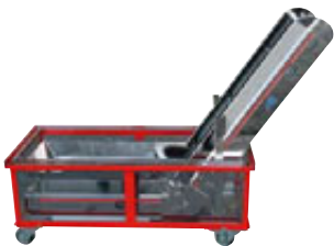
Cinta transportadora en agua
