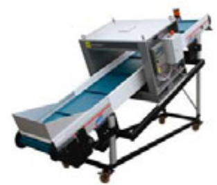
Cinta de alimentación de molino con detector de túnel
