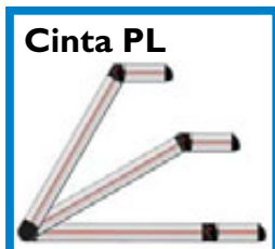
En todas las cintas transportadoras angulares MTF Multi-Tech, se puede ajustar el ángulo sin escalonamientos entre 0° y 60°.
