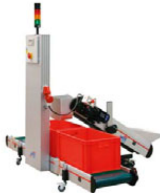
Almacenamiento temporal lineal con cinta de alimentación
