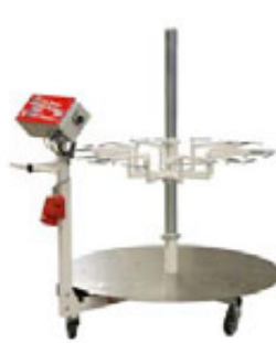
Equipo de recepción en versión zona limpia con la recepción amortiguada de envases y plato giratorio de acero inoxidable
