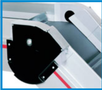
Étanchéité optimale de la bande dans tout le pli supérieur de la bande
