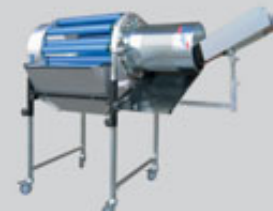
Tambour de séparation à rouleaux avec anneau d'admission du tambour perforé
