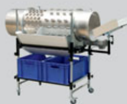
Combinaison de tambour perforé/ tambour de type "hérissron"
