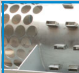
Détails d'une combinaison tambour perforé/tambour de type "hérissron"
