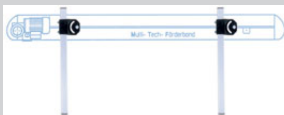
AM 140 , supports indépendants robustes et réglables en hauteur, convient pour différentes hauteurs de surface, telles que les gradations et les compartiments de machines.
