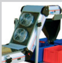
Ventilateurs de refroidissement
