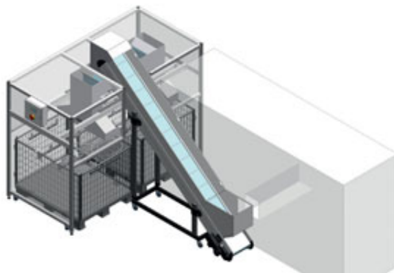
Remplissage de sacs à 12 tours avec bande de déplacement pneumatique et appareils de voie double face à 3 voies
