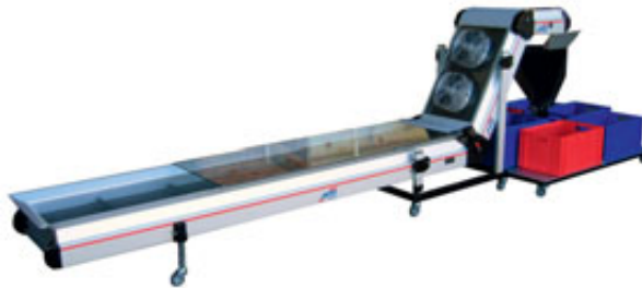
Refroidissement de pièces et stockage tampon
