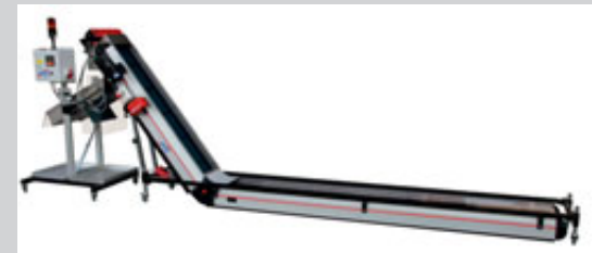
Conception pour salles propres avec bascule d'ionisation et de distribution
