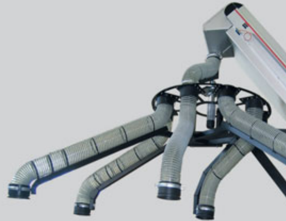
Installation spéciale pour le transport et la distribution automatiques des bouchons de boisson dans plusieurs grands conteneurs.
