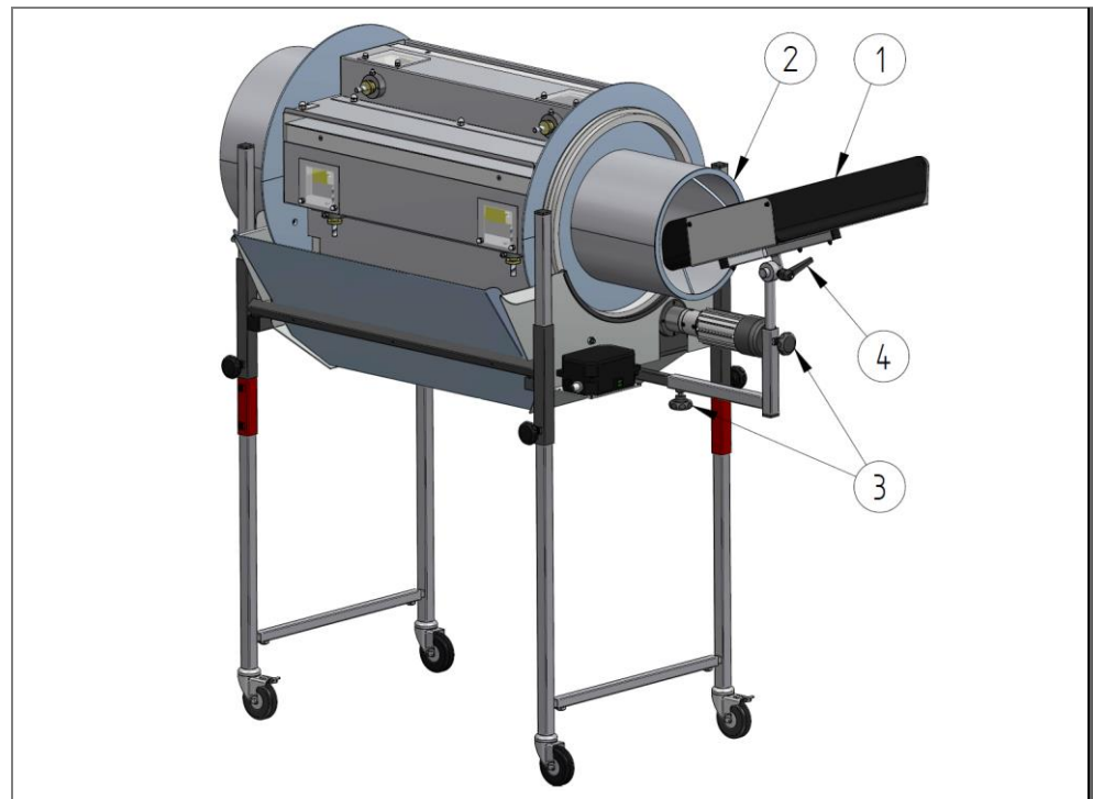
Fig. 11 : Réglages possibles pour la goulotte d'admission
