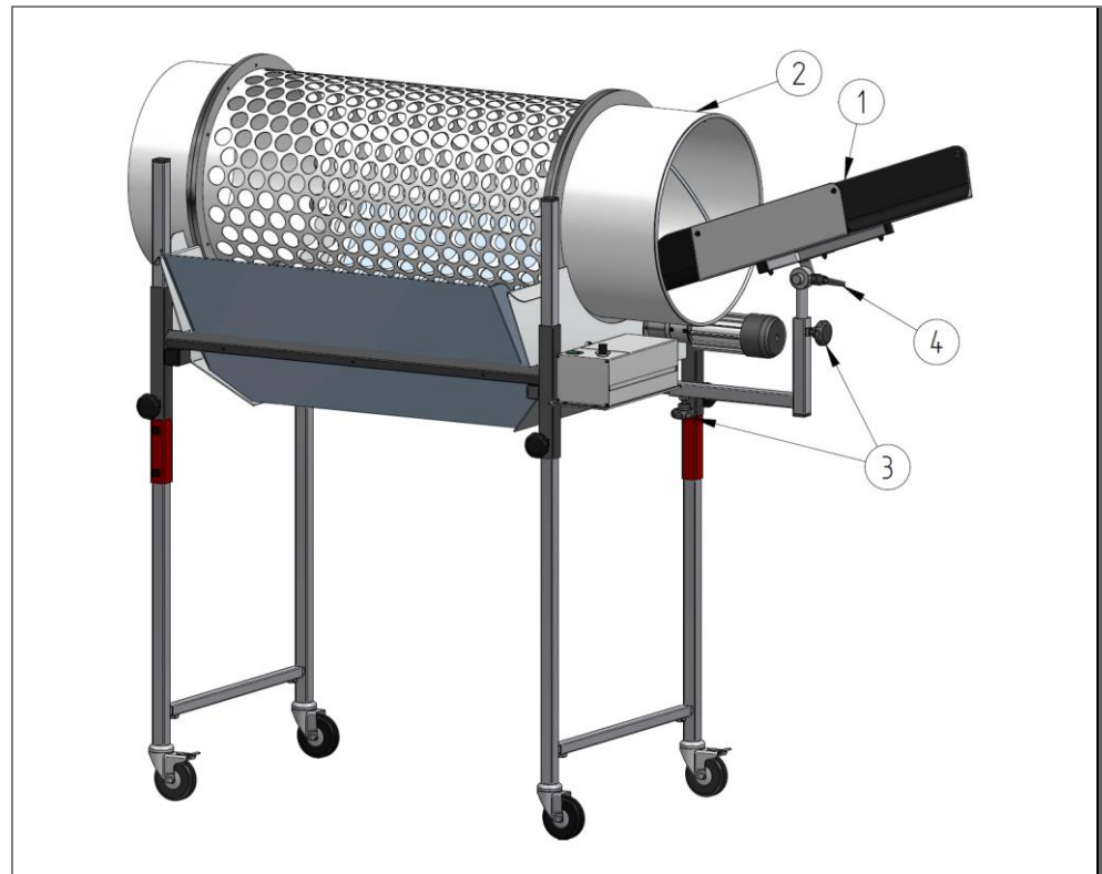
Fig. 10 : Réglages possibles pour la goulotte d'admission
