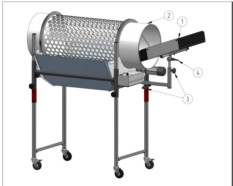
10. ábra: Az adagolócsúszda beállítási lehetőségei
