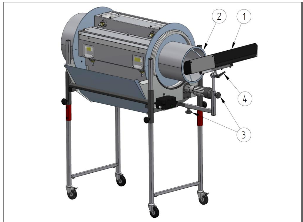
Rys. 11: Możliwości ustawienia zsuwni wlotowej
