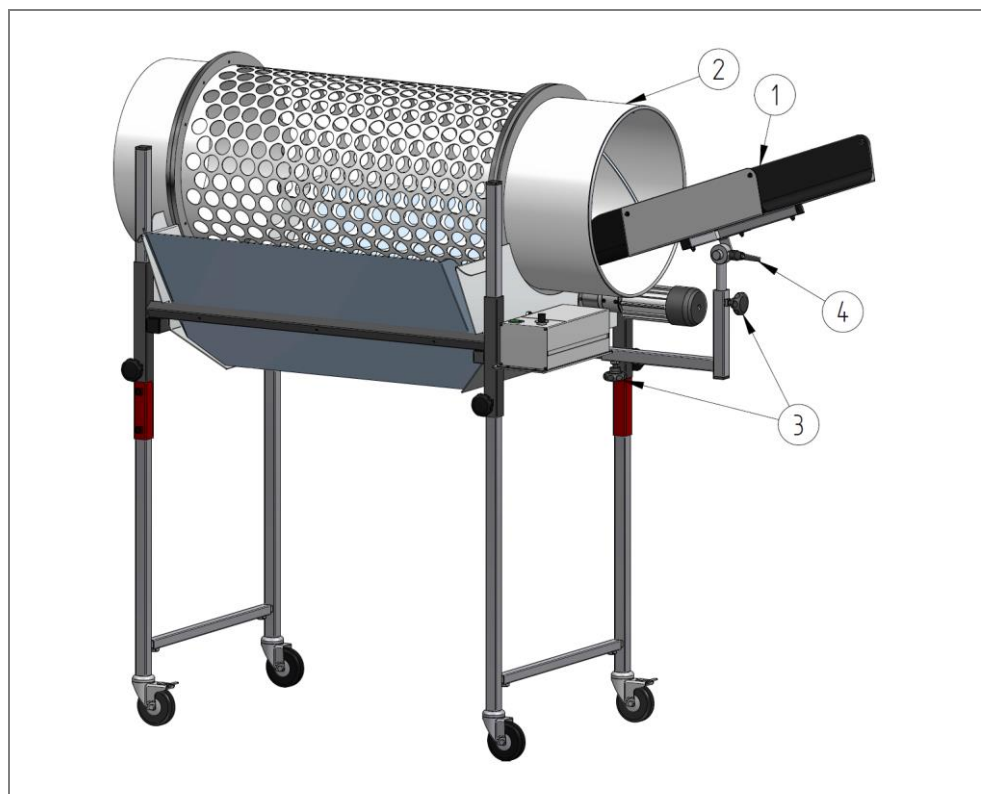
Rys. 10: Możliwości ustawienia zsuwni wlotowej
