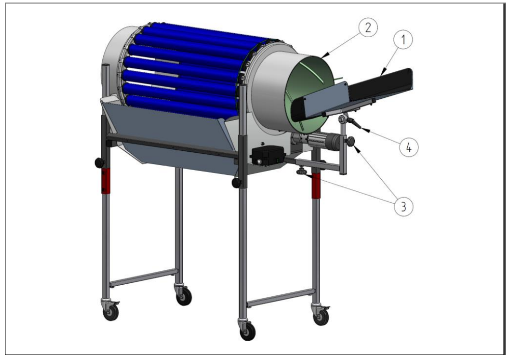
Rys. 12: Możliwości ustawienia zsuwni wlotowej
