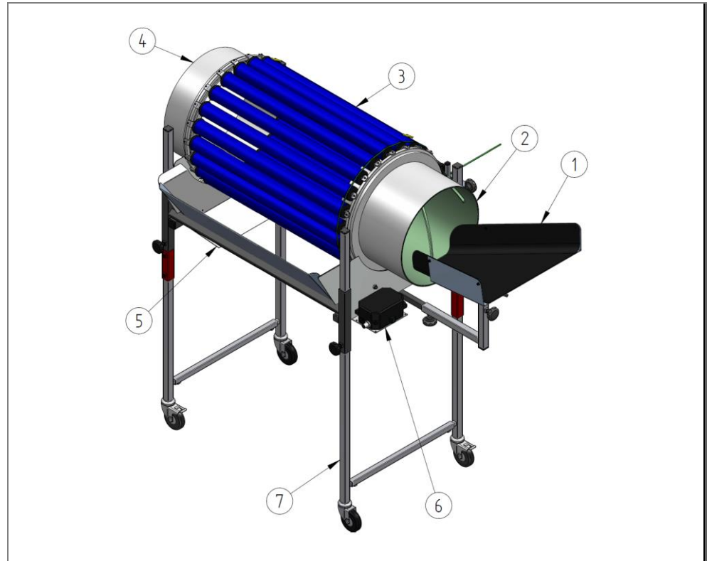
Rys. 3: Bęben separacyjny z pojedynczą regulacją
