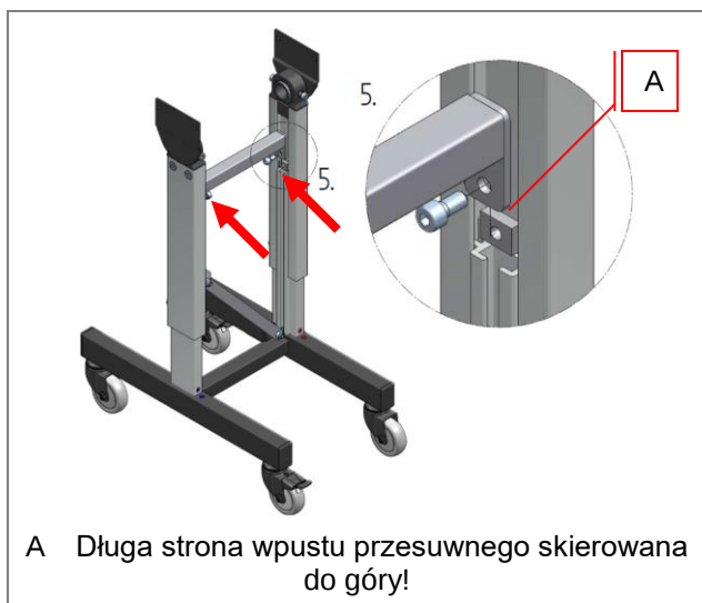
Rys. 34: Montaż ramy podstawy – HE 050/ HM 480
