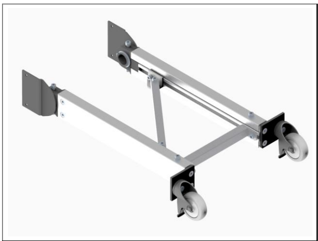
Rys. 23: Montaż ramy podstawy – AM 920 (przykładowy)
