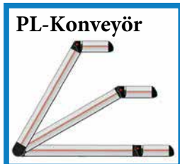
Tüm standart MTF Multi-Tech açılı konveyörler için, konveyör açıları 0° ile 60° arasında sürekli olarak ayarlanabilir.
