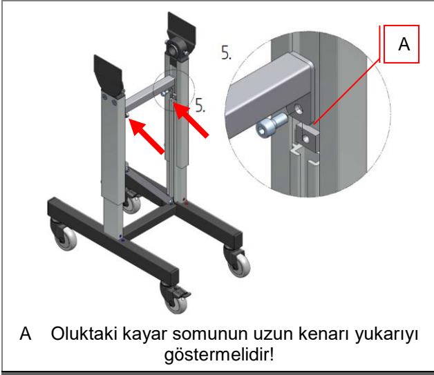
Şekil 34: HE 050 / HM 480 alt şasisinin montajı
