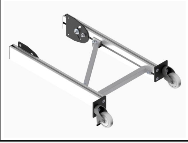
Şekil 30: AM 1030 alt şasisinin montajı (örnek)
