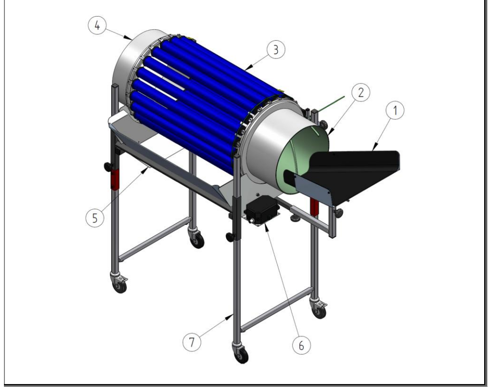
Şekil 3: Tek başına ayarlanabilen ayırma tamburu
